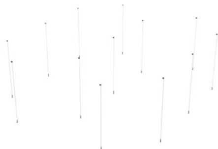
1. Przymocuj wszystkie zawiesia do stropu.
