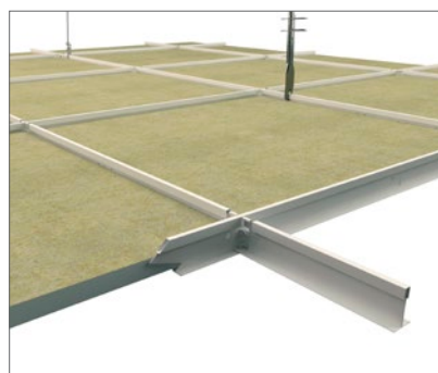
Profile główne i poprzeczne 38 mm o zwiększonej odporności na korozję, wykonane zostały ze stali obustronnie galwanizowanej ogniowo - warstwa 275 gramów cynku/m 2 i pokryte powłoką poliesterową o grubości 20µm.
