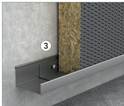
40 mm J-randprofiel (25/40/13 mm) en steunbeugel worden gebruikt voor ondersteuning bij montage van meerdere wandpanelen boven elkaar of boven de grond. Als u het 1 mm dikke J-profiel gebruikt, heeft u geen steunbeugels nodig.
