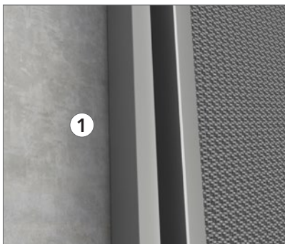
HAT profielen worden rechtstreeks bevestigd tegen de wand.
