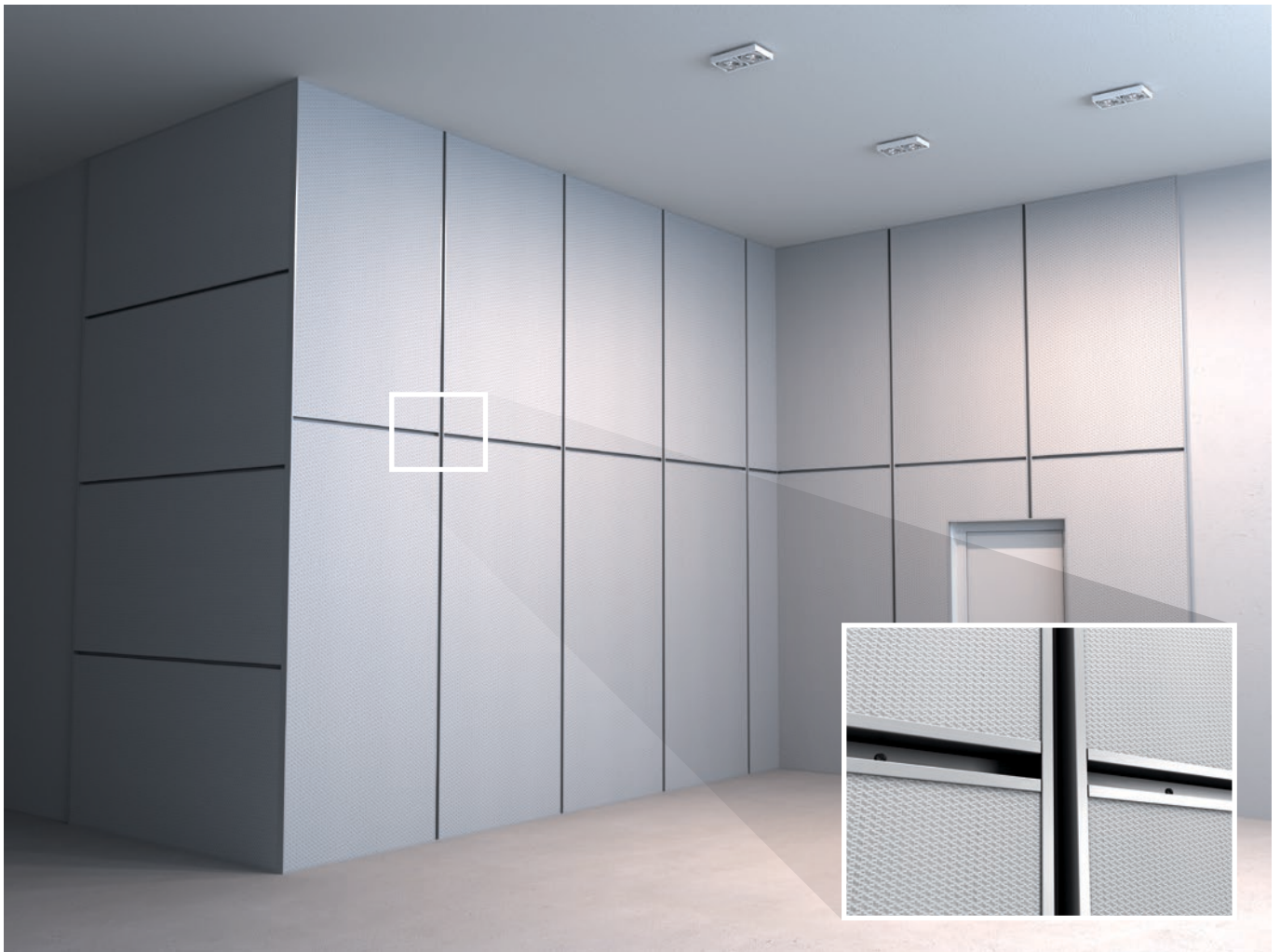
3.1 Alle Rockfon VertiQ-wandpanelen en HAT-profielen geïnstalleerd.
