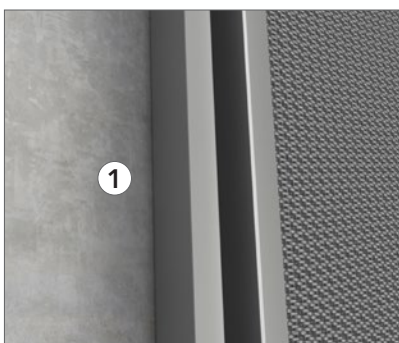
Les profils HAT se fixent directement au mur.
