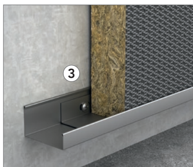
Profil périphérique en J 40 mm (25/40/13 mm) et support pour la base des panneaux montés sur plusieurs hauteurs ou au-dessus du sol. Lorsqu'on utilise un profil en J de 1 mm, il n'est pas nécessaire d'utiliser des supports.
